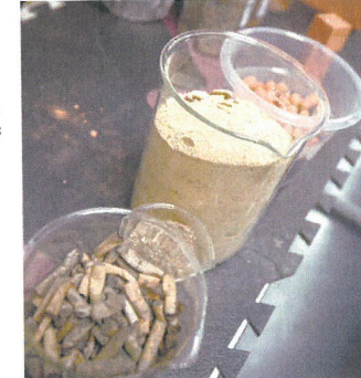
↑ Pontas são trituradas e misturadas com argila antes de cozerem e formarem o tijolo
